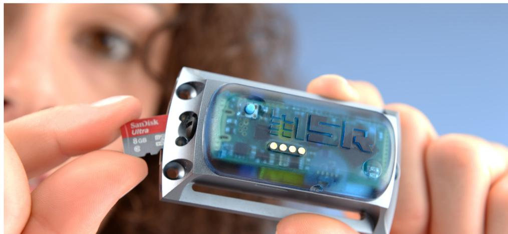
El registrador de datos equipado con un sensor de aceleración de 3 ejes de alta resolución ( $\pm 15$  g o  $\pm 200$  g) le proporciona valiosos datos de medición sobre impactos, choques y vibraciones. Con su ratio de medición de 1600/s, su elevada capacidad de memoria y su reducido consumo de corriente, el MSR 165 es perfecto para aplicaciones dentro del ámbito de la supervisión de transporte, diagnóstico de errores y pruebas de carga.
